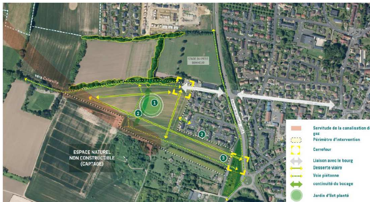
Parti d'aménagement à l'échelle proche
