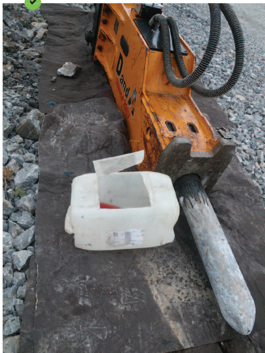
Équipement posé sur géotextile absorbant.
