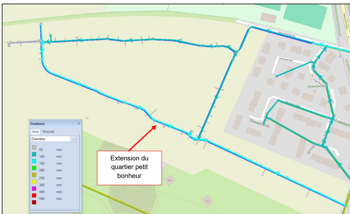
Figure 2-1 : Tracé du réseau AEP relatif au projet d'aménagement du quartier petit bonheur à Ouistreham sur le logiciel Piccolo
