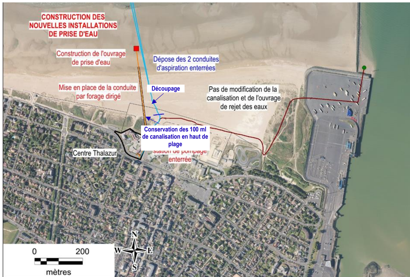
Figure 25 : Opérations de pose et de dépose des canalisations de pompage d'eau de mer
