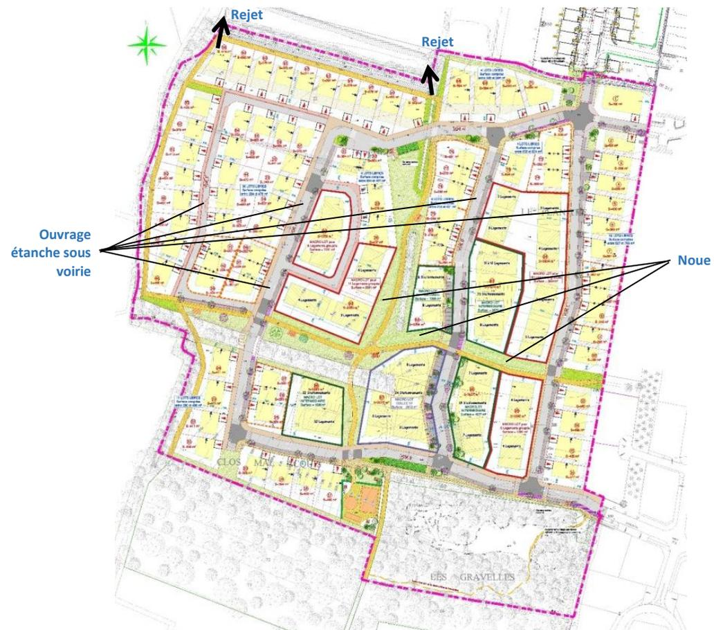
Situation des ouvrages d'infiltration, sans échelle
