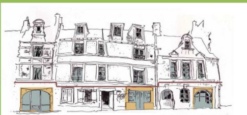
respect des lignes horizontales des hauteurs d'étage devantures à rez-de-chaussée
